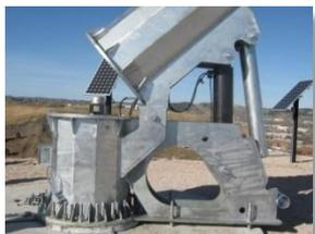
Tutte le torri dei modelli RPI sono idrauliche permettendo la manutenzione a terra della turbina. Non è quindi più necessaria nessuna gru per l'installazione o manutenzione della macchina.
